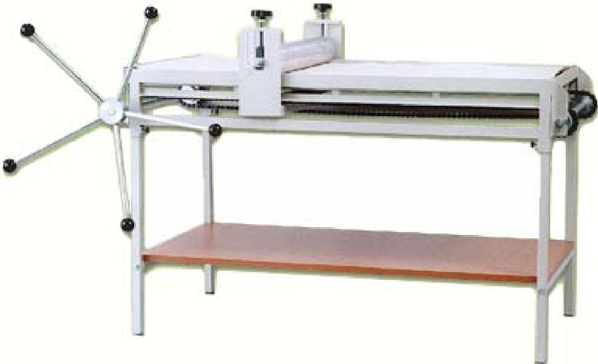
Il Tavolo Stendi Argilla permette di ottenere sfoglie di Argilla da 1 a 70 mm di spessore. La regolazione della lastra avviene avvitando o svitando i due volantini che si trovano all'estremità del rullo.
